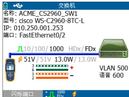
100 Mbps 铜缆链路, PoE 连接至端口 2
